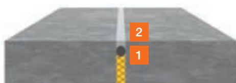
Lodret/vandret fuge, tåler ikke overkørsel
